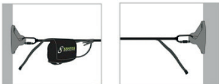
Caso 1: Existen puntos de anclaje (EN 795 Tipo A)
